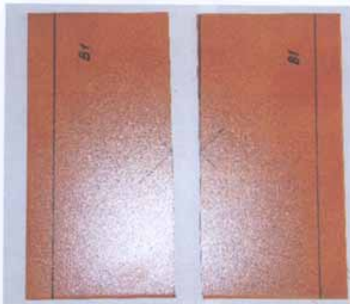
Fotografía 4. Aspecto de una de las baldosas después de ser sometida al ensayo de resistencia a flexión.
